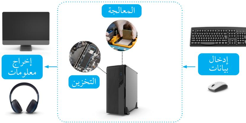
الشكل (1-1): رسم توضيحي لمبدأ عمل جهاز الحاسوب.
